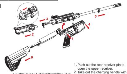
電池及護木的拆裝方法 sembling for Battery and Handguard
