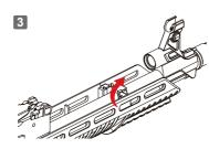
將下護木環固定鈕向上扳起。 Flip up the lower handguard fixing lever.
