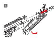
將下護木固定環向前拉,即可卸下下護木。 Push the lower handguard forward to remove.
